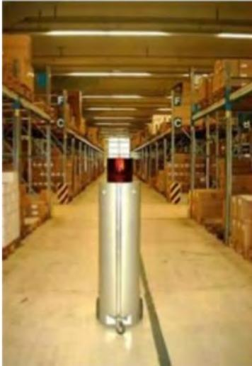
Fig. 1.1 - Robot móvil de vigilancia para interiores.
