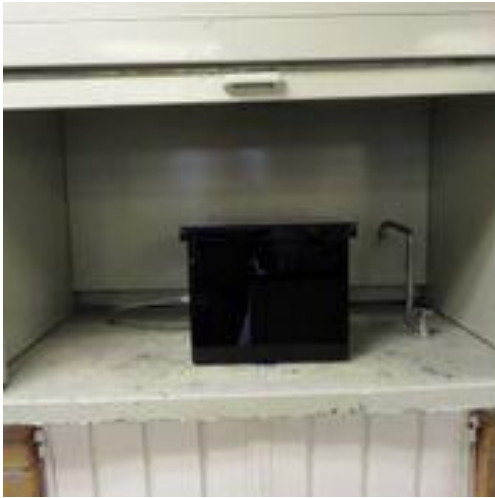
Imagen 4. Cámara de CO 2 en campana de extracción
