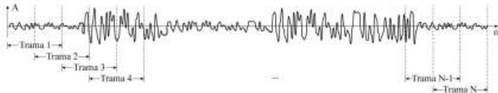
Figura 5.6: Ejemplo de OLA de una señal con traslape de 50% [9].
