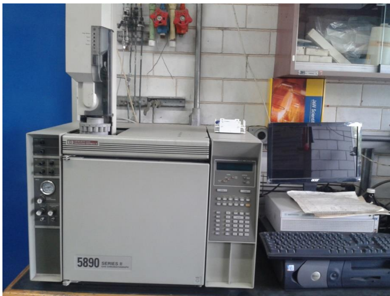
Figura 3.9. Cromatógrafo de gases en el que se siguió el avance de las reacciones.
