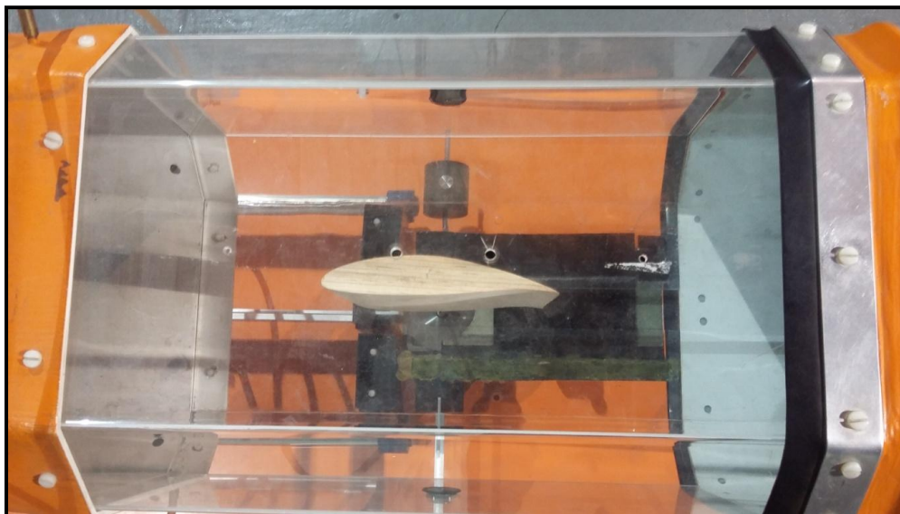
Ilustración 31 Perfil aerodinámico montado en el túnel de viento [21]
