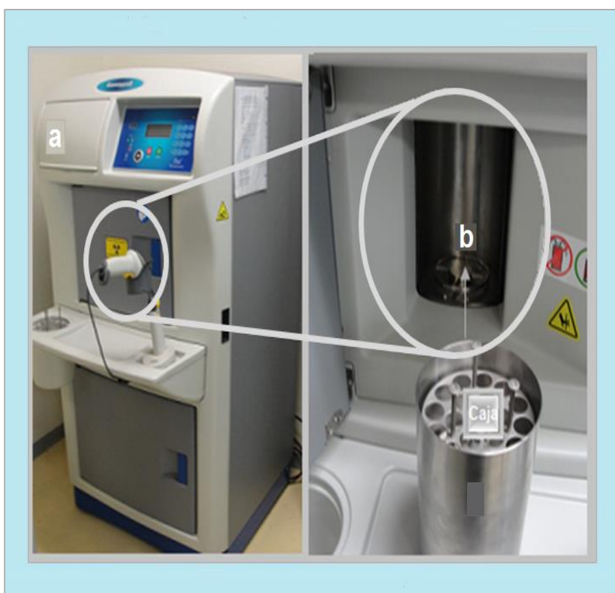
Figura 3.2 a) Irradiador autoblandado Gammacell-3000; b) cámara de irradiación para colocación del portamuestra.
