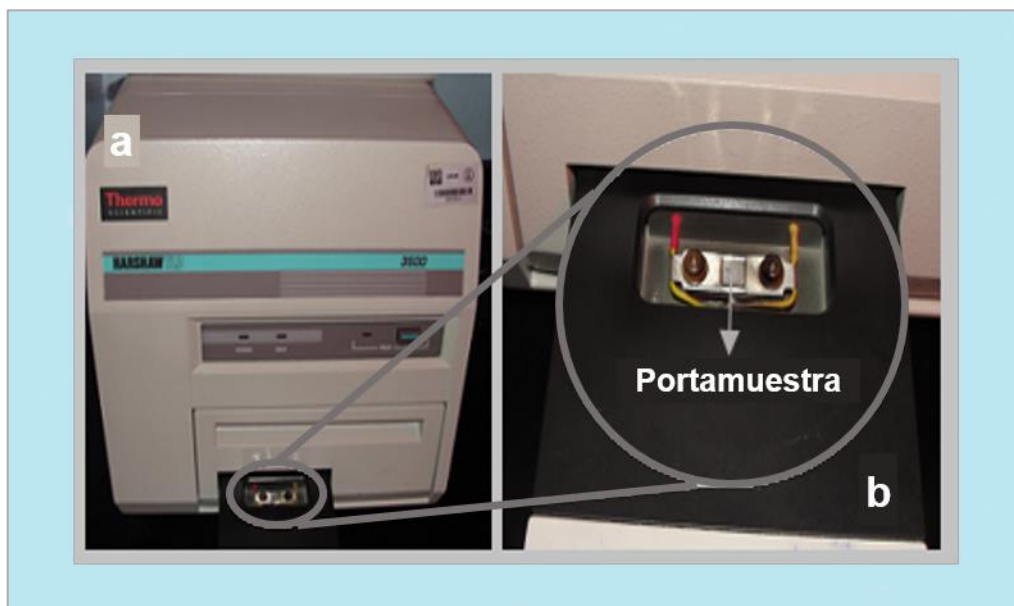
Figura 3.5 a) Equipo de termoluminiscencia Harshaw TLD 3500; b) plancheta de calentamiento.
