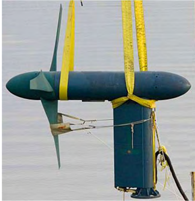
Figura 2.3 Turbina de eje horizontal
