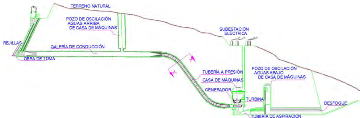
Figura 4.14 Perfil de obra de generación en caverna
