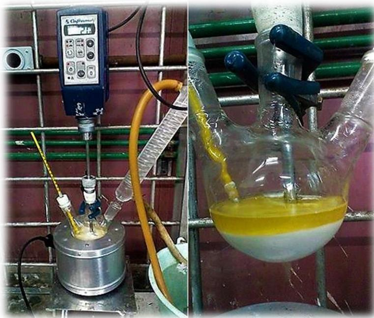
**Figura 30** Decoloración de TPA por hidrólisis
