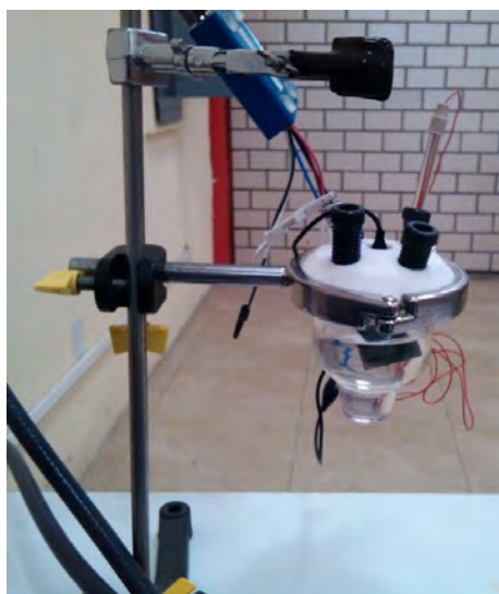
Figura 4.4: Montaje de la celda electroquímica
