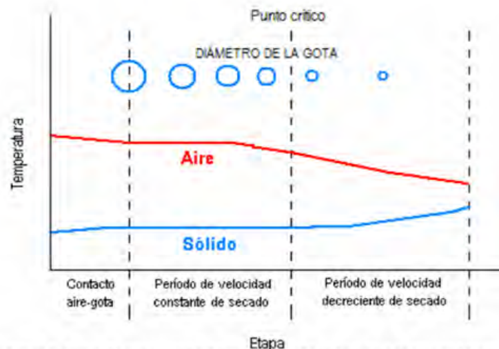
Figura 5. Curva de evaporación del agua durante el secado por aspersión y los cambios morfológicos que sufre la gota asperjada (Treyball, 1996)
