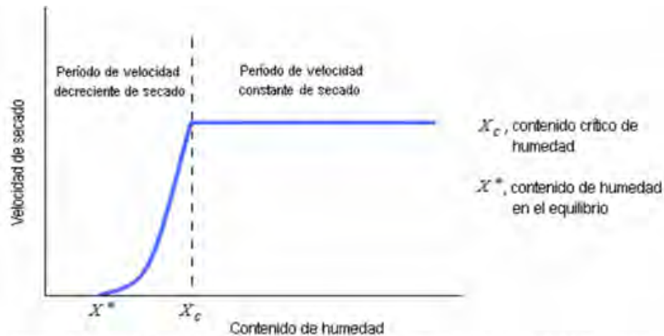
Figura 4. Curva de evaporación del secado por aspersión en función del contenido de humedad
