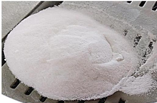
*Figura 5.1.*  $\beta$ -Li<sub>5</sub>AlO<sub>4</sub> pulverizado.
