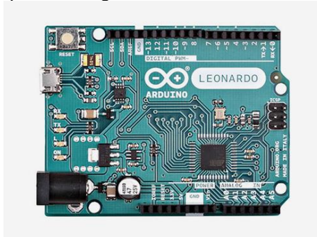
Figura 38. Microcontrolador Arduino Leonardo.
