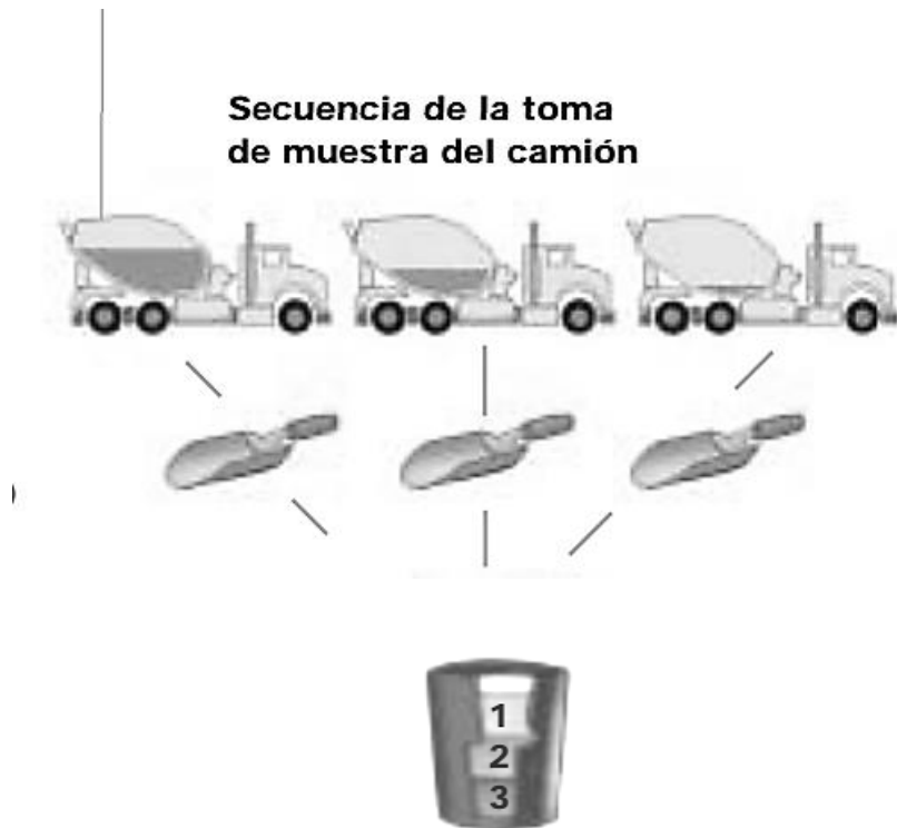
Imagen 2.3.- Muestreo de la carga total del concreto.
