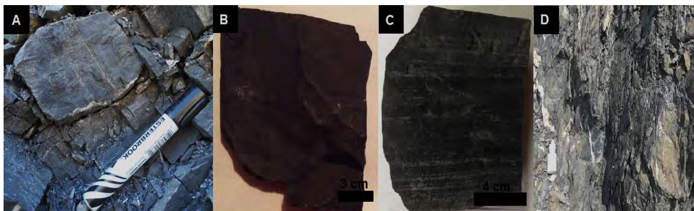
Figura 6.3 Litología de la roca caja. A) Caliza con finas laminaciones de pirita. B) Caliza con finas laminaciones y de alta densidad. C) Caliza con un alto contenido en arcillas y sílice amorfo (posible pedernal). D) Caliza con lentes de lutita carbonatada.
