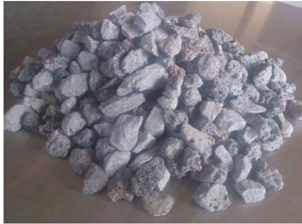
Fig. 2-21 Caras fracturadas del agregado grueso
