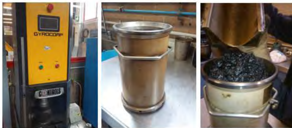
Fig. 4-7 Elaboración de cilindros de concreto asfáltico (Rangel Galicia, 2015)
