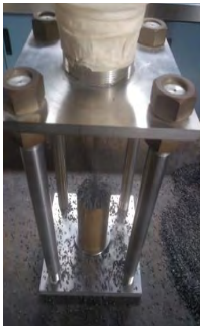
Fig. 2-22 Dispositivo para medir la angularidad del agregado fino (Josephia, R., 2015)
