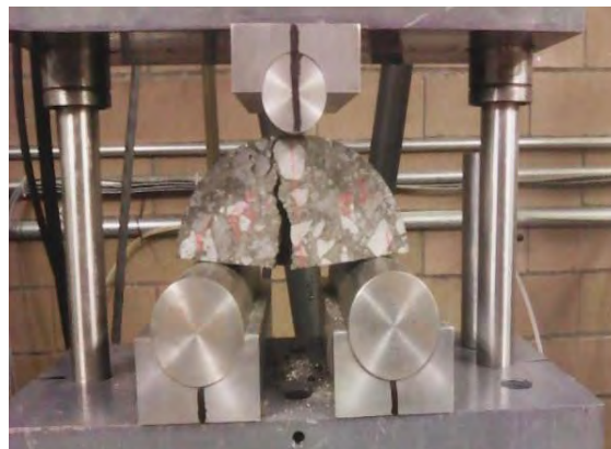
Fig. 4-29 Falla de probeta en ensayo SCB
