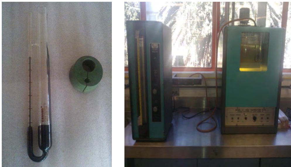
Fig. 2-28 Ensayo de viscosidad dinámica (Josephia, R., 2015)
