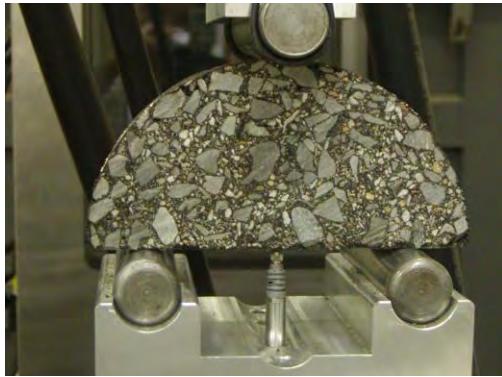
Fig. 4-28 Arreglo para ensayo SCB (Huang , Shu, & Tang, 2005)
