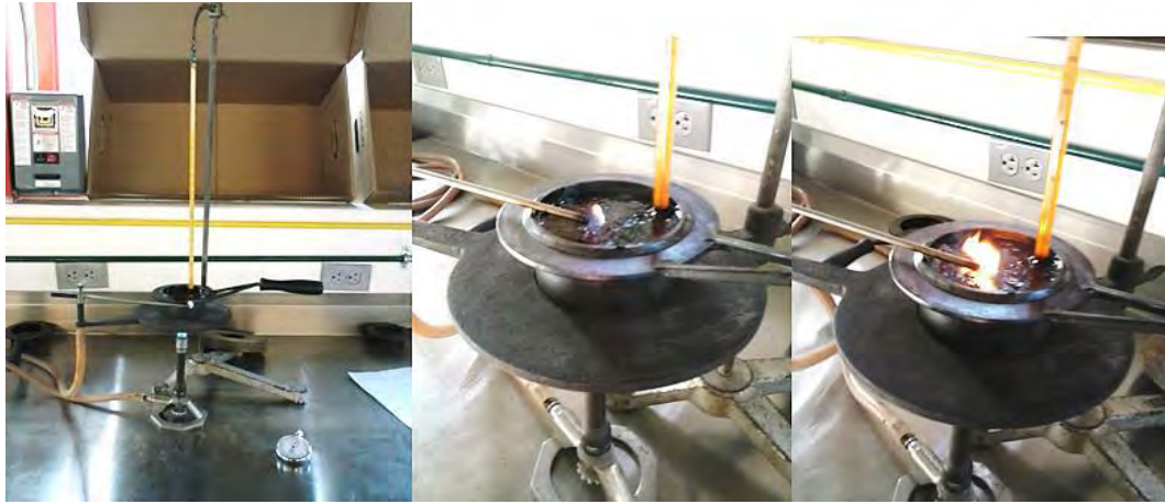
Fig. 2-34 Ensayo de punto de inflamación (Martínez, O., 2014)
