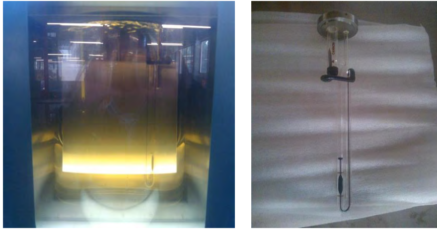
Fig. 2-30 Ensayo de viscosidad cinemática (Josephia, R., 2015)
