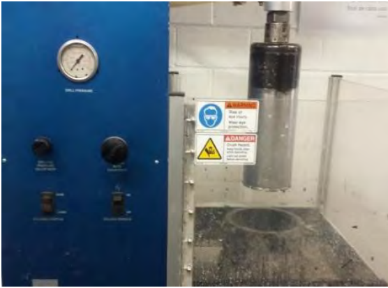
Fig. 4-8 Extracción del núcleo de la mezcla asfáltica
