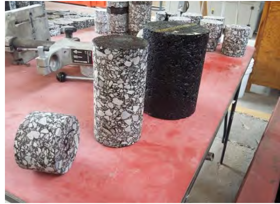
Fig. 4-8 Extracción del núcleo de la mezcla asfáltica
