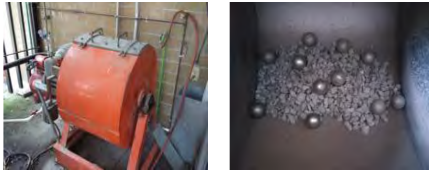
Fig. 2-25 Equipo para prueba de Desgaste de Los Ángeles (Rangel Galicia, 2015)
