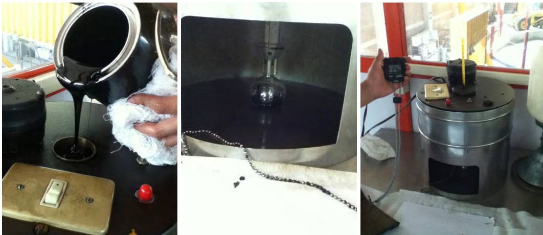
Fig. 2-29 Ensayo de viscosidad Saybolt-Furol (Josephia, R., 2015)
