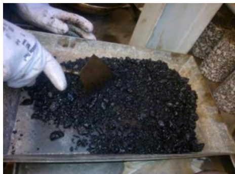
Fig. 4-6 Mezcla asfáltica para gravedad máxima teórica G_{mm} (Rangel Galicia, 2015)
