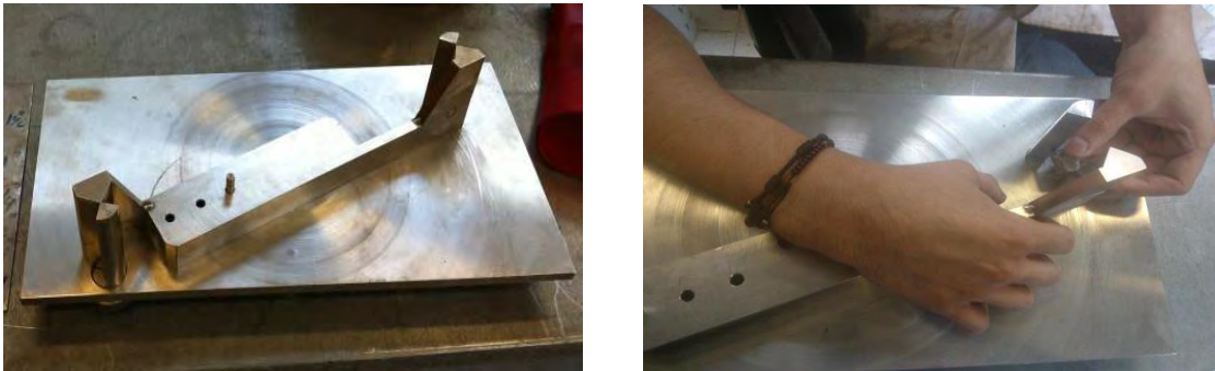
Fig. 2-23 Dispositivo para partículas alargadas y planas
