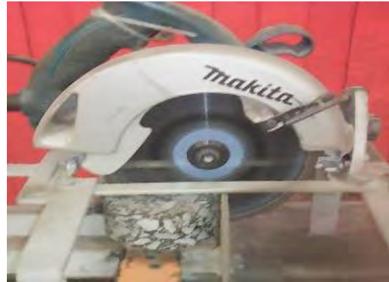
b) Probetas ensayo SCB
