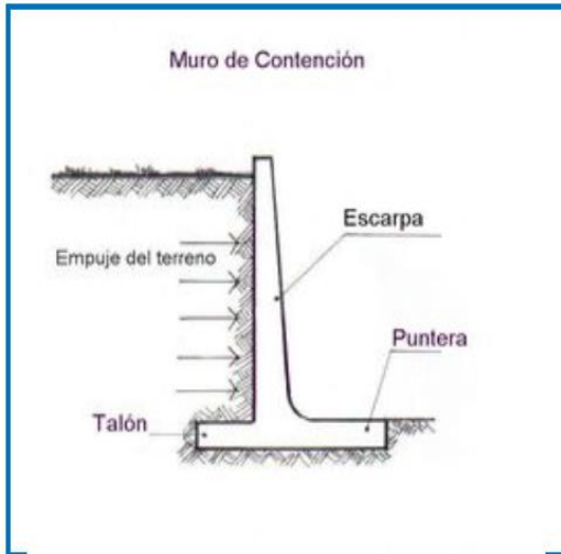
Figura 23. Principales características del muro de contención (COPECO, 2013).
