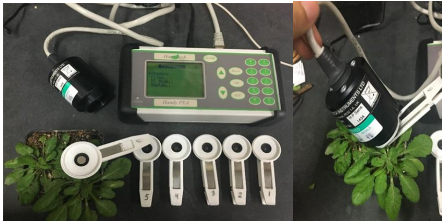
Figura 7. Medición de la fluorescencia con el aparato Handy Pea (Hansatech). Se utilizaron tres plantas de Arabidopsis thaliana en una maceta. A) Se indica como fueron colocadas las leafclips (pinzas) y el B) sensor head.
