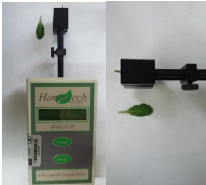
Figura 8. Medición del contenido de clorofila con el dispositivo CL-01 Chlorophyll Content Meter de una hoja de Arabidopsis thaliana . Se indica cómo fue colocada en la pinza.
