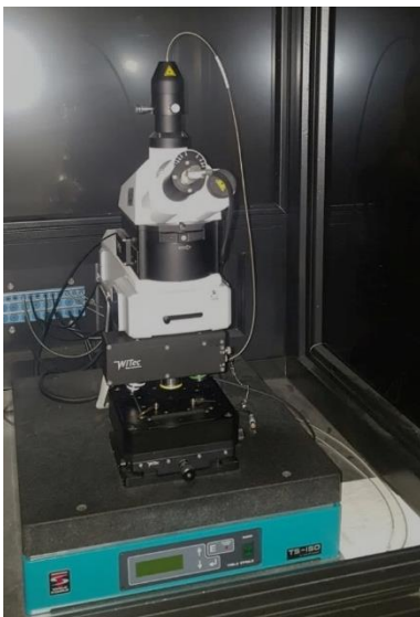
Figura 2.1. Microscopio de fuerza atómica acoplado al equipo Raman-LUNA.
