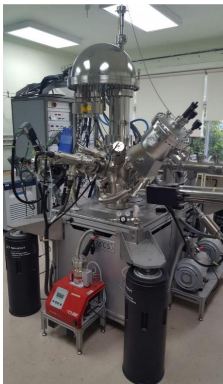
Figura 2.2. Equipo de fotoespectroscopia de rayos X de la marca SPECS, CNYN-UNAM.
