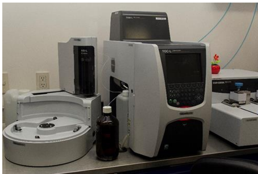
Figura 2.6. Analizador de carbono orgánico total TOC-L Shimadzu-LUNA.
