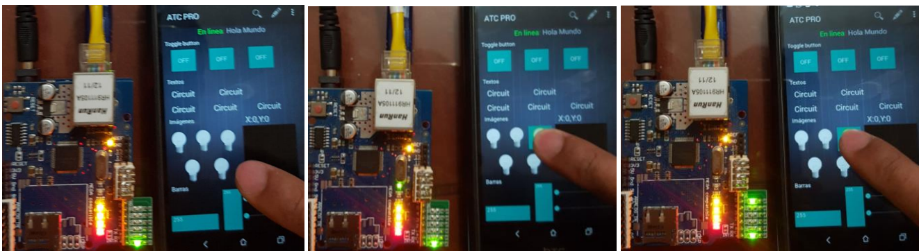
Figura 5.26. Activación de un Long Touch Button. a) Al liberar se envía un comando "OFF" ('a' para este ejemplo); b) No se envía ningún comando al toque; c) Después de 1s aproximadamente, se envía un comando "ON" ('A' en este ejemplo).
