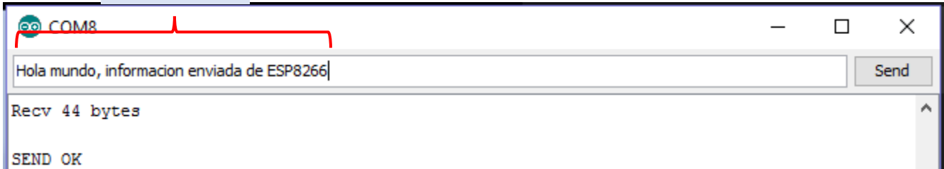
Figura 5.18. Envío de datos del módulo ESP8266 a la aplicación.
