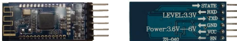
Figura 1.14. Módulo HM10 basado en el TI CC2540.
