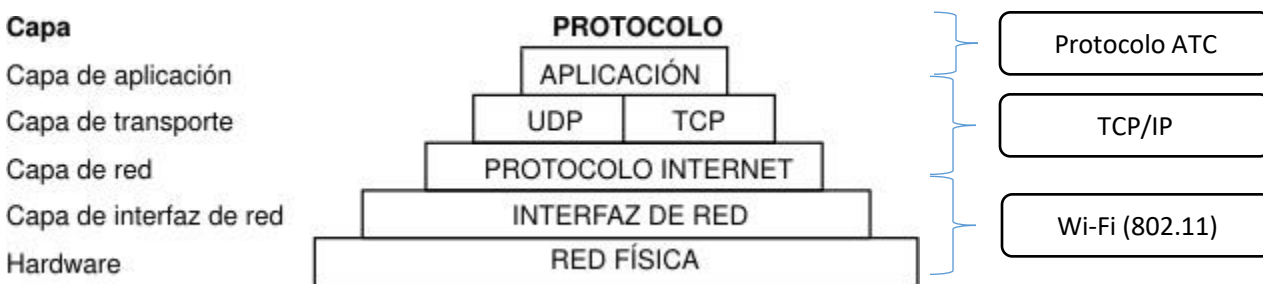
Figura 3.15. Pila de protocolos TCP/IP [47] (izquierda) y su relación con ATC (derecha).
