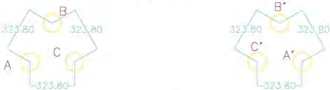
Fig. 5.15 Distancias entre centros de cables
