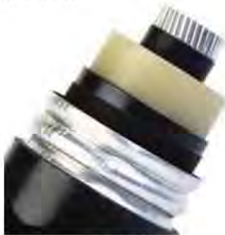
Fig. 1.20 Pantalla metálica tipo tubo corrugado
