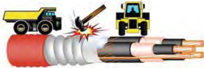
Fig. 1.22 [4] Uso de las armaduras
