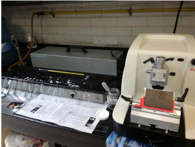
Figura 15.- Micrótopo Leica ubicado en Unidad de Morfo fisiología, se realizaron cortes de 7 micrómetros con navaja de bajo perfil, y plancha de extendimiento de muestras con solución Ruyter.
