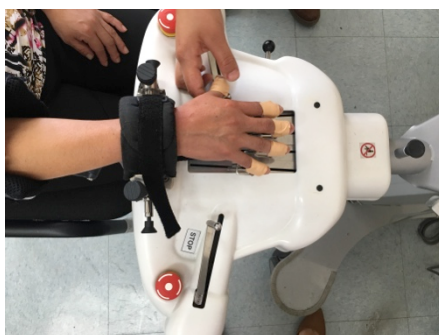
Figura 2. Posicionamiento de las articulaciones de la mano en el dispositivo robótico Amadeo® .
