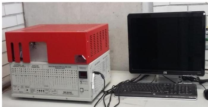
*Ilustración 14. Cromatógrafo de gases Alltech SRI modelo 8610C*
