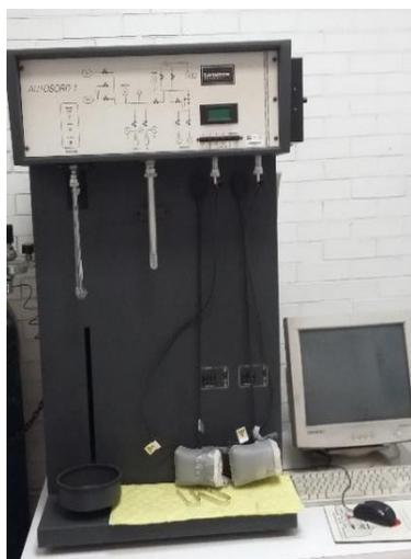
*Ilustración 13. Equipo Quantachome Autosorb Automated Gas Sorption*
