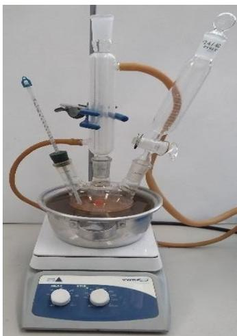
*Ilustración 12. Montaje para la obtención del catalizador magnético*
