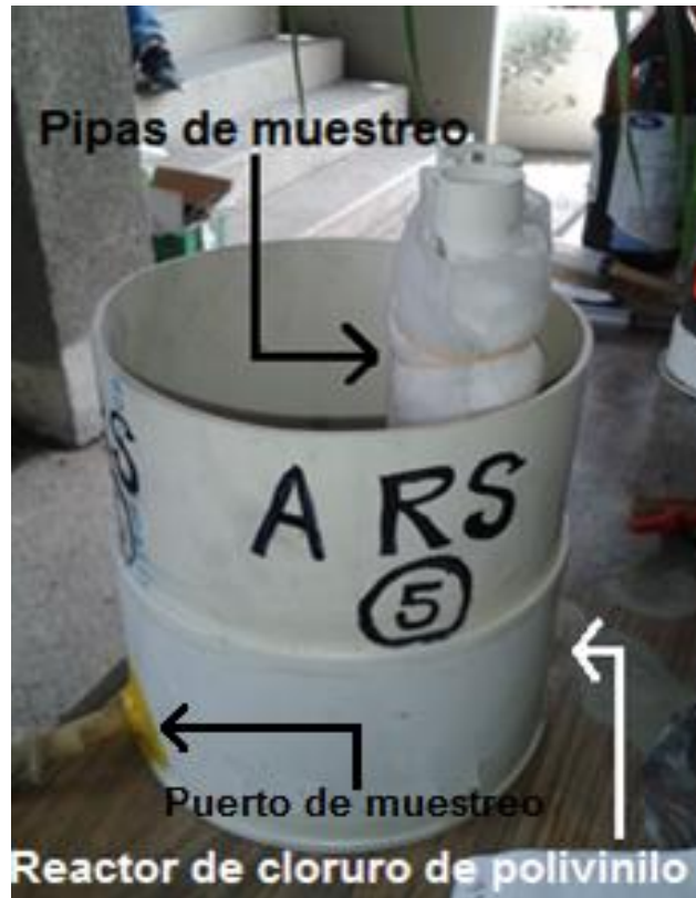
Figura 3.2. Reactor de cloruro de polivinilo con puerto y pipas de muestreo
