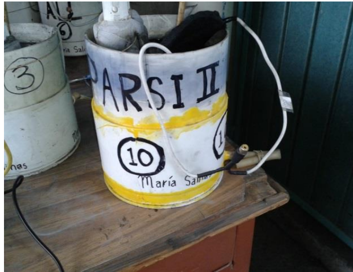
Figura 3.5. Colector de corriente unido al ánodo y al cátodo
