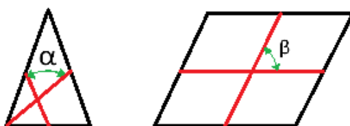
Figura 4.6: Torcimiento ( skew ) para elementos triangulares y cuadrangulares. Torcimiento de triángulo = 90^\circ - \alpha . Torcimiento de cuadrado = 90^\circ - \beta
