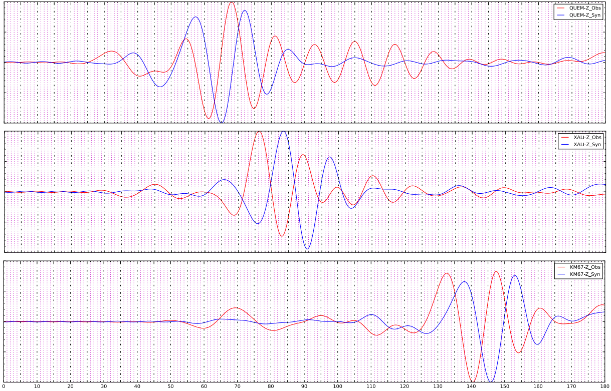
Figura 3.11: Comparación entre sismogramas sintéticos obtenidos con el modelo inicial propuesto \mathbf{M}_0 y los sismogramas observados, para las estaciones QUEM, XALI y KM67 para la componente z, del evento 20050814, filtrados a 0.1 [Hz].
