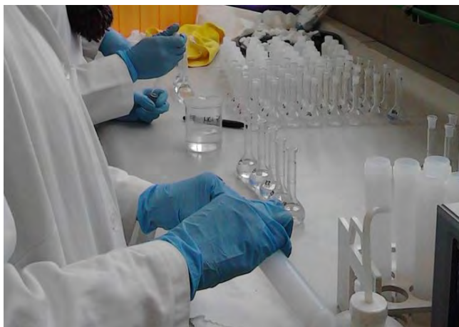
FIGURA 10. Vaciamiento del contenido de los vasos de teflón a los matraces de 25ml.
