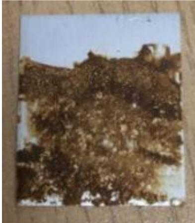
Figura 4.18. Probeta con fluoropolímero después de 105 días
