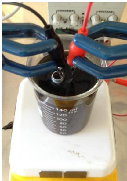
Figura 4.20. Anodizado de tubo de aluminio.
