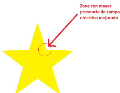
Figura 82. Forma de estrellas de cinco picos modeladas por el método FDTD en el trabajo de Zhu, et al., en el 2016.
