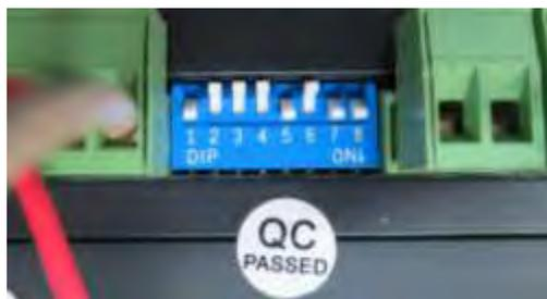
*Fig. 52. Dip switch del driver para motor a pasos*
