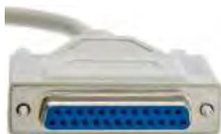
Fig. 55. Conexión DB25
