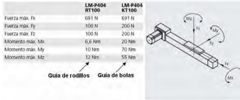
Fig. 8 Datos tipo de fuerzas y momentos de dos ejes de mismo diámetro pero diferentes guías.
