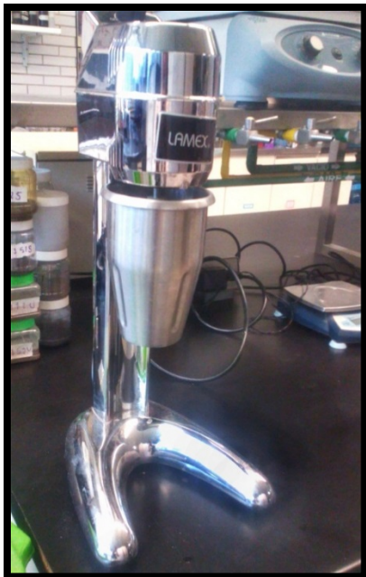
Figura 9. Motor eléctrico para la dispersión de agregados.
