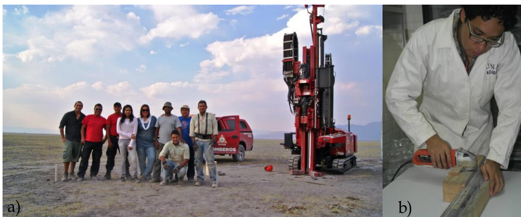
Fig. 2. a) Equipo de perforación de núcleos sedimentarios en la cuenca del lago Santiaguillo. b) procesamiento y corte transversal de los núcleos en el laboratorio.
