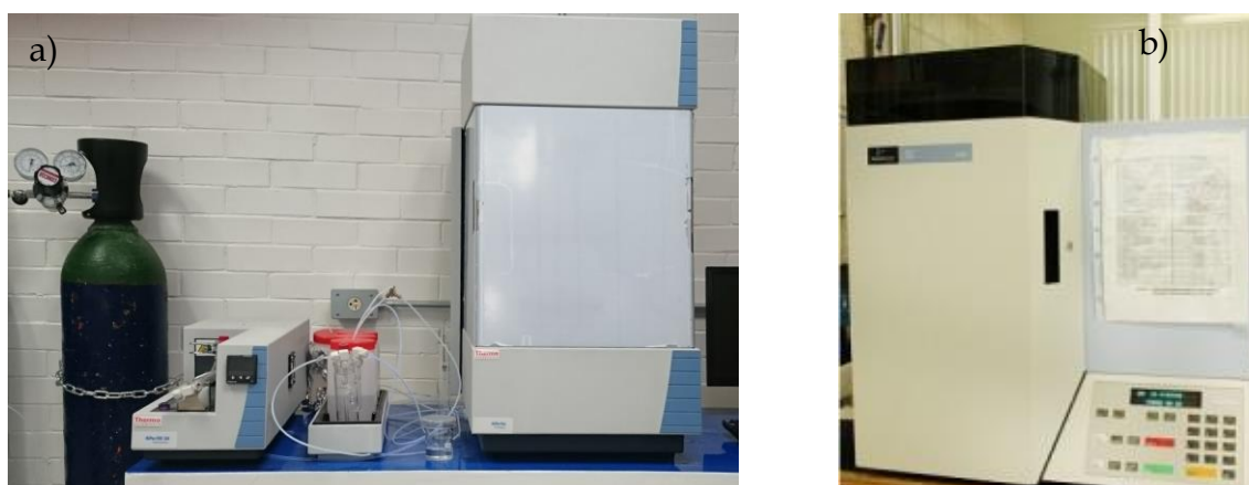
Fig. 4. a) Equipo HiperTOC de la marca Thermo Scientific para medir la abundancia de carbono inorgánico (IC) y carbono total. La resta de IC al carbono total da como resultado la abundancia de carbono orgánico (OC). b) Equipo Perkin Elmer Series II CHNS/O que mide la abundancia de Nitrógeno total (TN) en la muestra.
