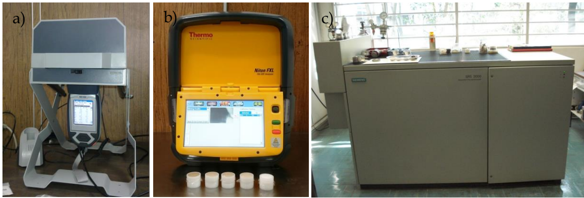
Fig. 3. Equipos de Fluorescencia de rayos X para medir las concentraciones de elementos mayores y traza de los sedimentos. a) Niton XL3t y b) Niton FXL 950 de la marca Thermo Scientific. c) equipo convencional de FRX SRS 3000 marca Siemens.
