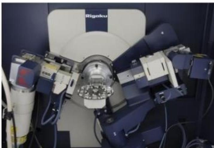
Fig. 3.3 Equipo de difracción de rayos X Rigaku-Ultima IV system
