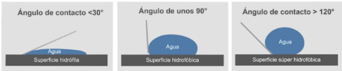
Fig. 3.5. Esquema del ángulo de contacto de una gota en contacto con una superficie
