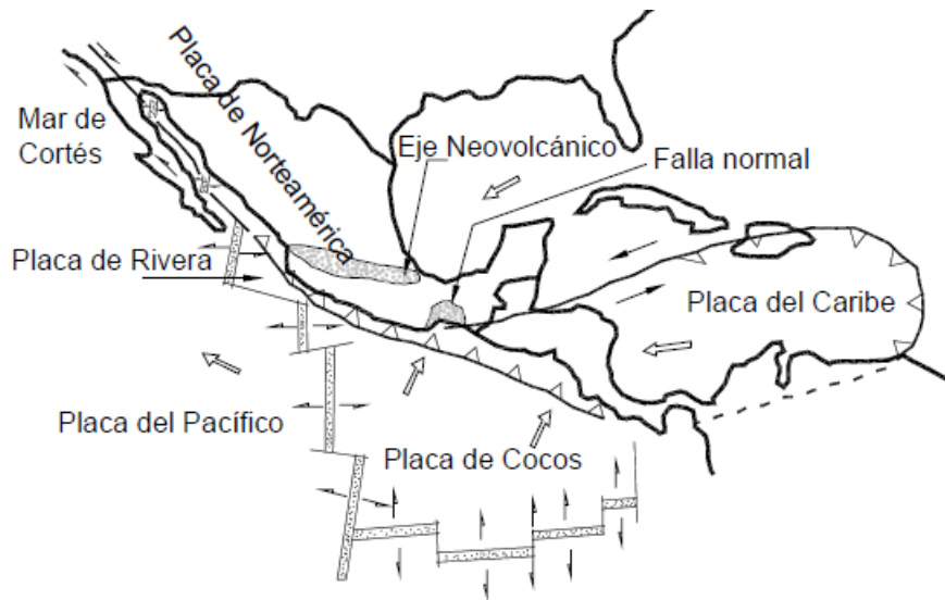
Figura 1.1 Ubicación de los sistemas causantes de los cuatro tipos de sismos que afectan a la Ciudad de México (Rosenblueth 1987)
