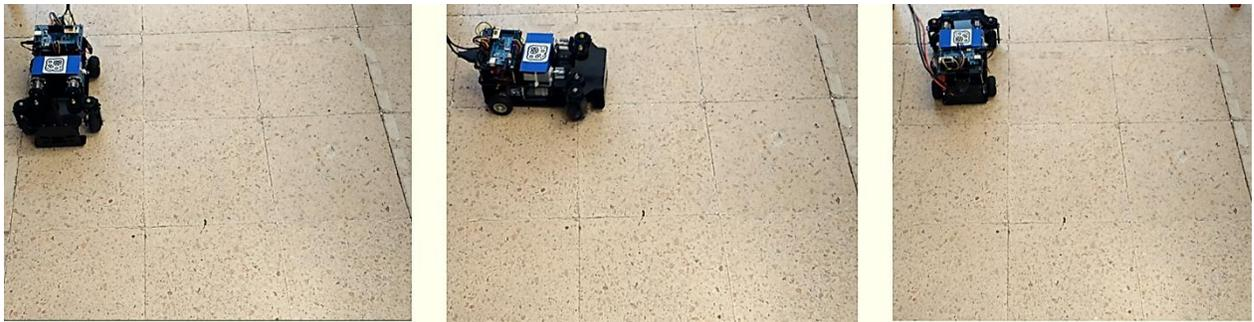
Figura 4.4 Modelo con dirección Independiente en prueba de radio de giro hacia la izquierda.
