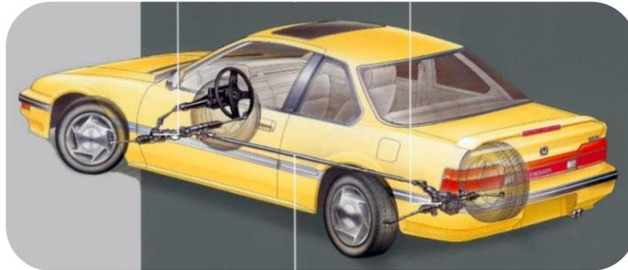
Figura 1.2. Honda Prelude (1987). Sistema mecánico 4WS
