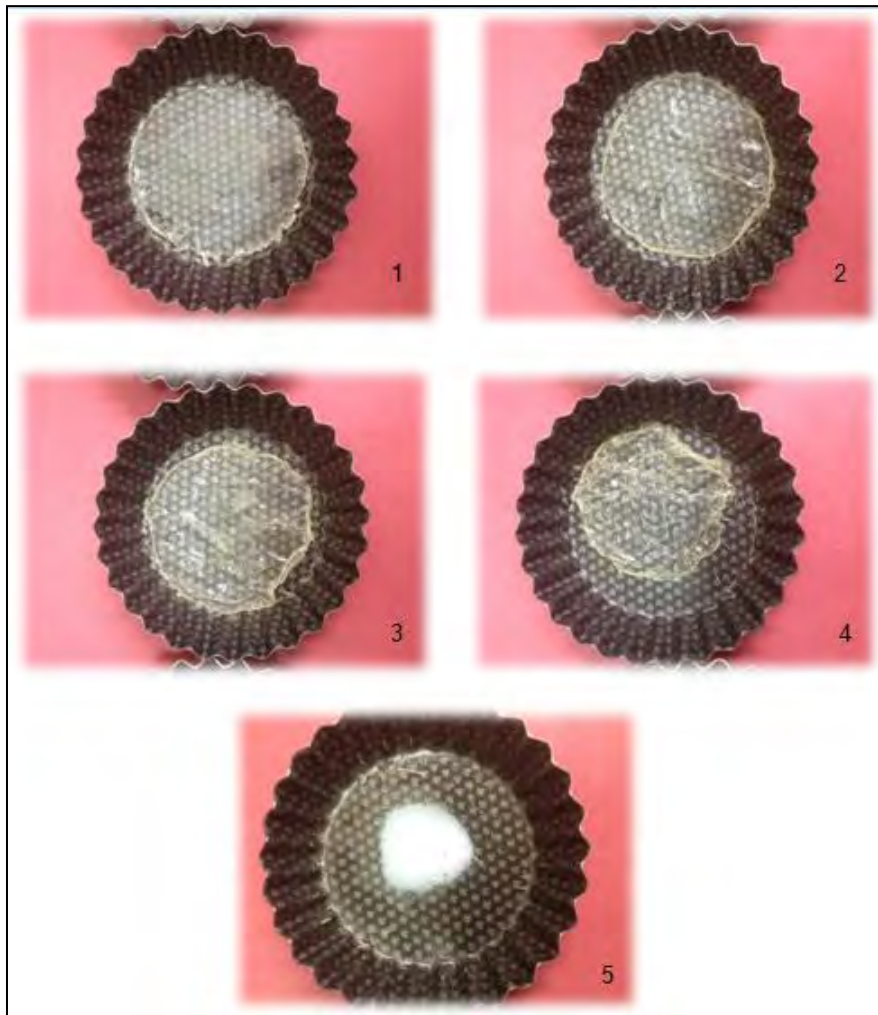
Figura 17. Películas 1-5 realizadas con tetrahidrofurano
