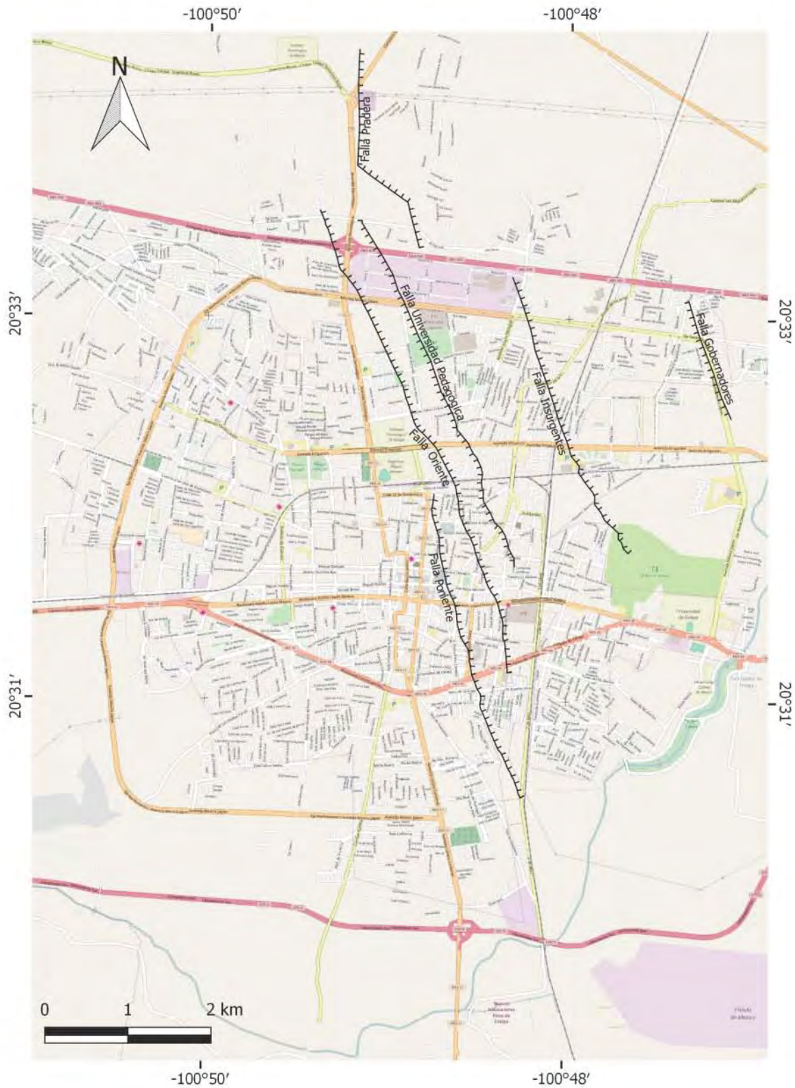
Figura 2.6. Mapa de localización de las fallas urbanas de Celaya. La base cartográfica es de OpenStreetMap y la localización de fallas fue modificada de Huizar-Álvarez et.al. (2011)
