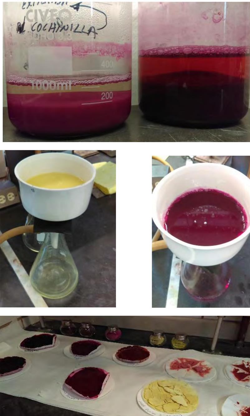
Figura 4.11. Proceso sintético para la creación de pigmentos laca. Lacas rojas precipitadas en disolución y proceso de filtrado en matraz kitasato, así como proceso de secado de lacas rojas y amarillas.
