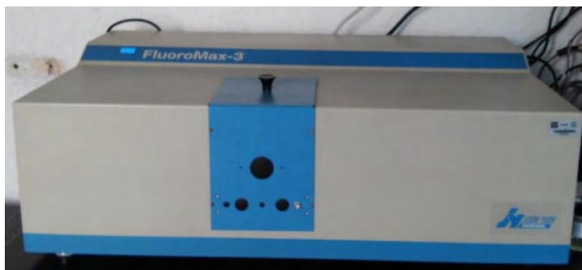
Figura 4.5. Espectrofluorímetro Fluoromax-3 de Horiba.
