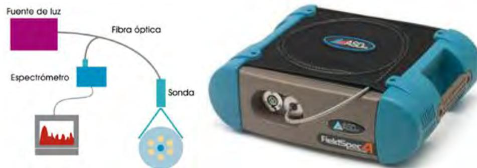
Figura 4.2. Esquema básico de un equipo Vis-NIR y equipo FieldSpect4 de ASD.
