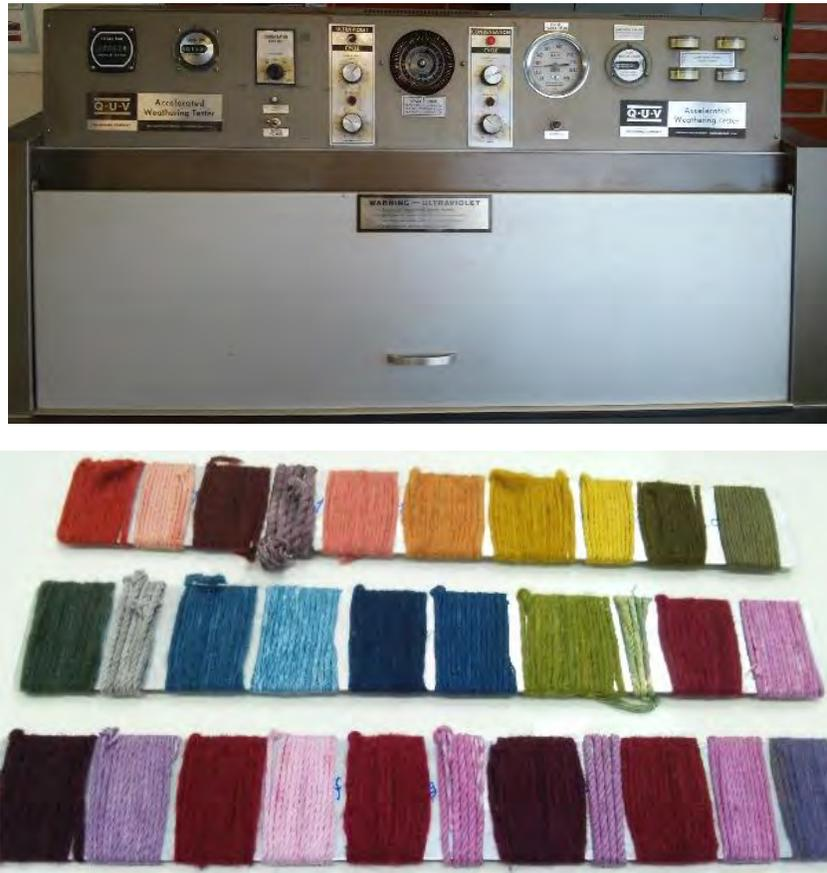
Imagen 4.10. Cámara de envejecimiento Q-U-V y muestras de fibras teñidas para envejecimiento.
