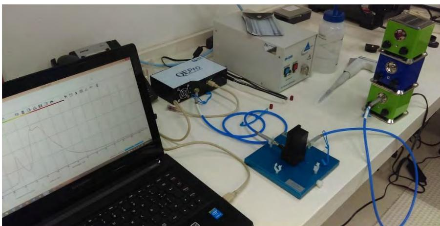
Figura 4.6. Espectrofotómetro QEPro de Ocean Optics e iluminantes.
