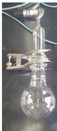
**Figura 23.** Reactor de vidrio donde fue introducido el portaobjetos con el cristal de cloruro de sodio.
