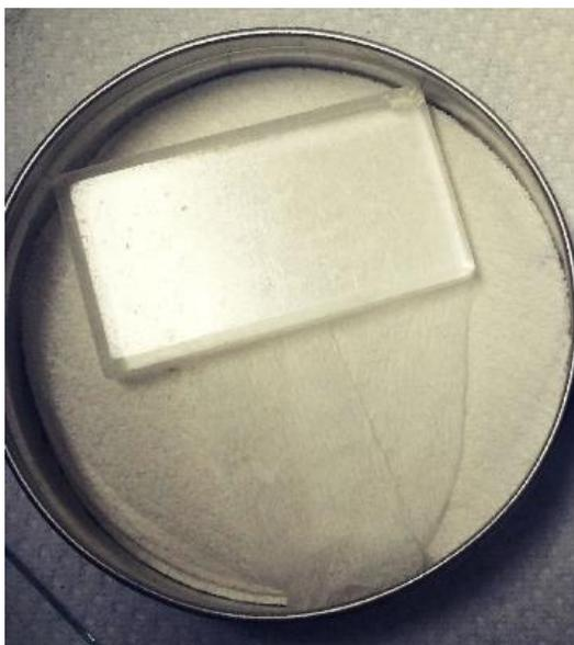
**Figura 21.** Ejemplo de ventana de NaCl empleada para los experimentos.
