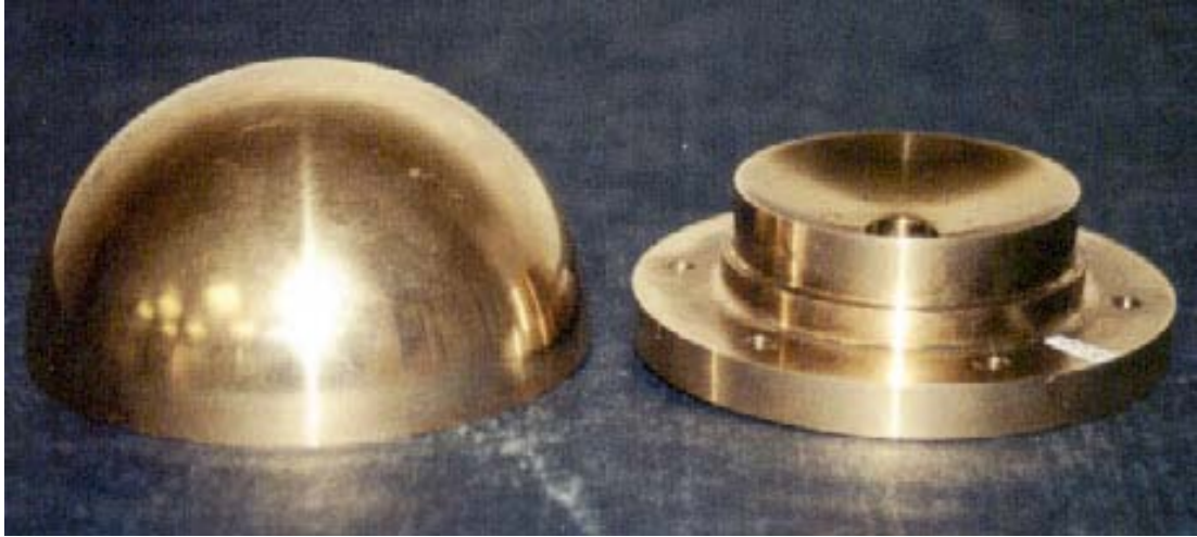
Figura 2.2: El balero y la copa del simulador de [25], maquinados en bronce fosforado.
