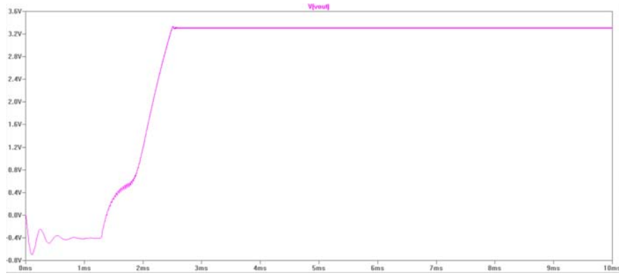
Figura 4.1: Señal del voltaje de salida de la fuente de 3.3 [V].
