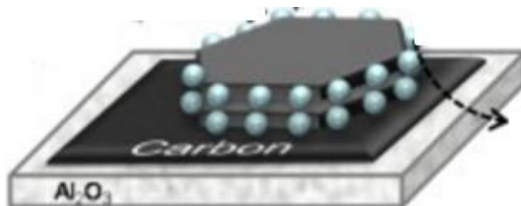
Figura 2.3.2. Superficie de la alúmina recubierta por carbón [34].
