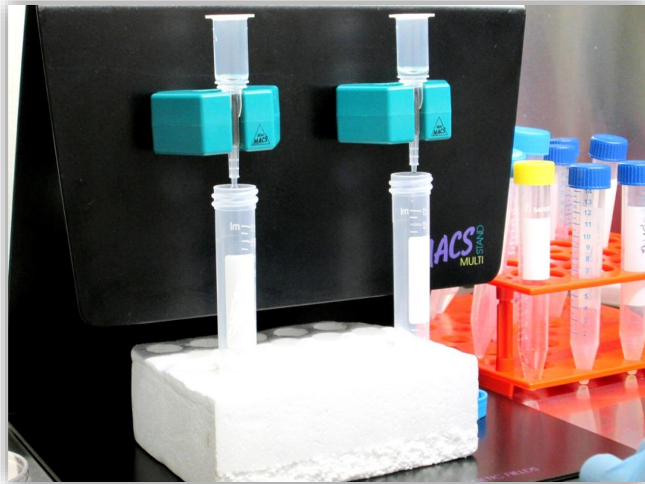
Fig.11 Separación celular por medio de MACs. Foto tomada del Laboratorio Académico de Ingeniería Tisular y Medicina Traslacional
