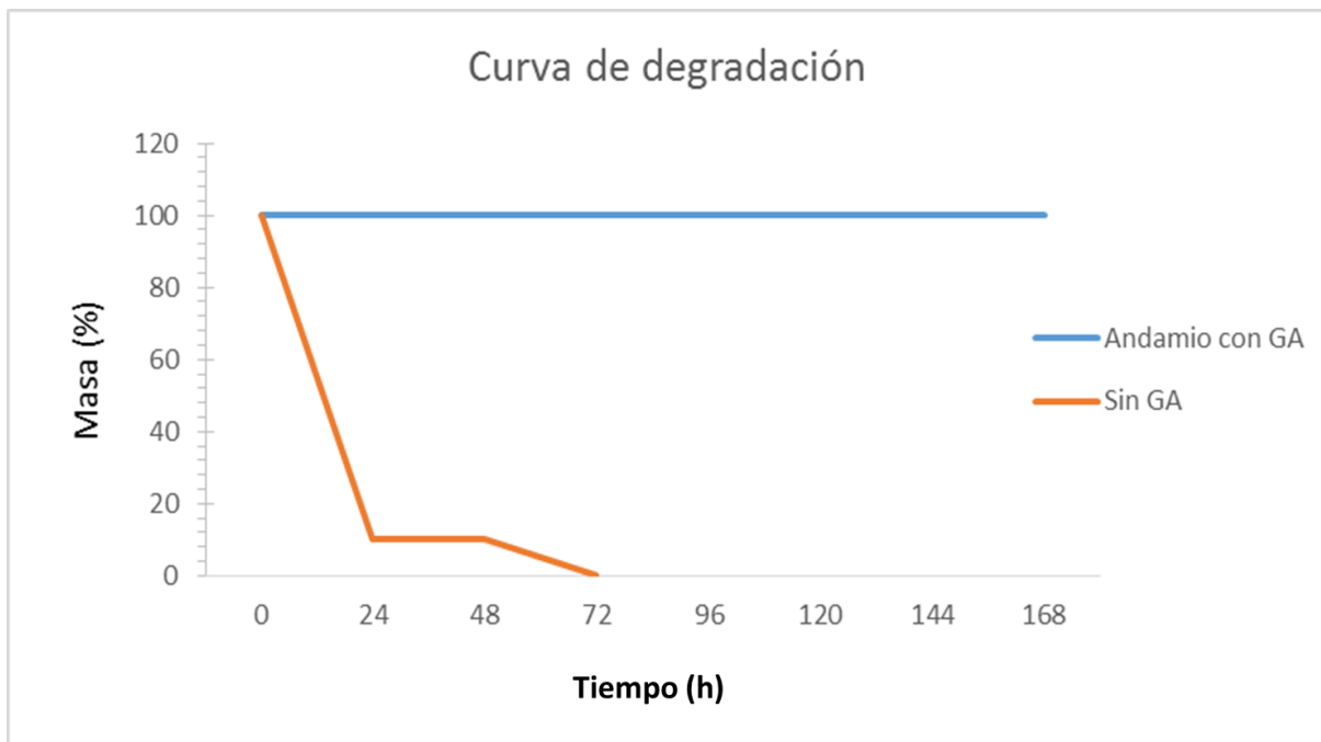
Figura 25. Porcentaje de degradación de andamios con y sin GA durante 7 días. El porcentaje de masa del andamio sin GA decayó hasta un 0% tras 72 h de experimentación.
