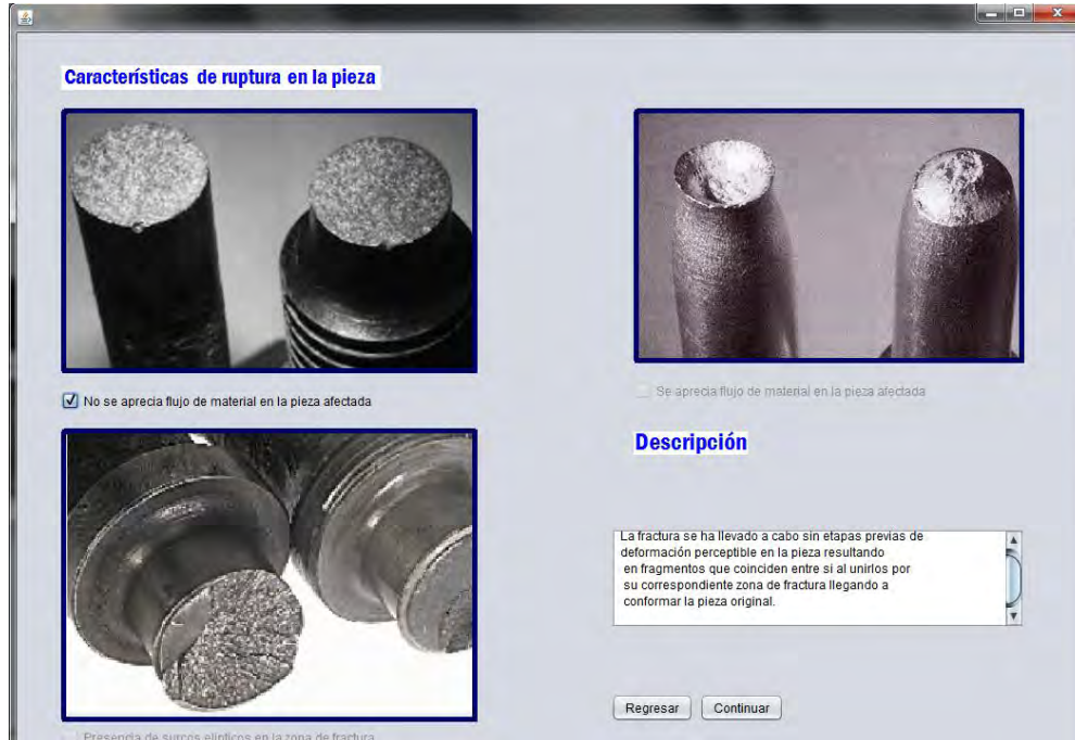
Figura B.31 Características de ruptura en la pieza, no se observa flujo de material en la pieza.
