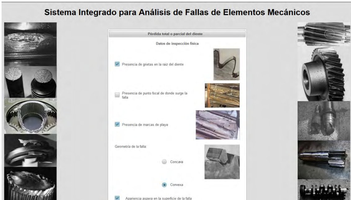
Figura C.7 Pérdida total o parcial del diente, primera parte.
