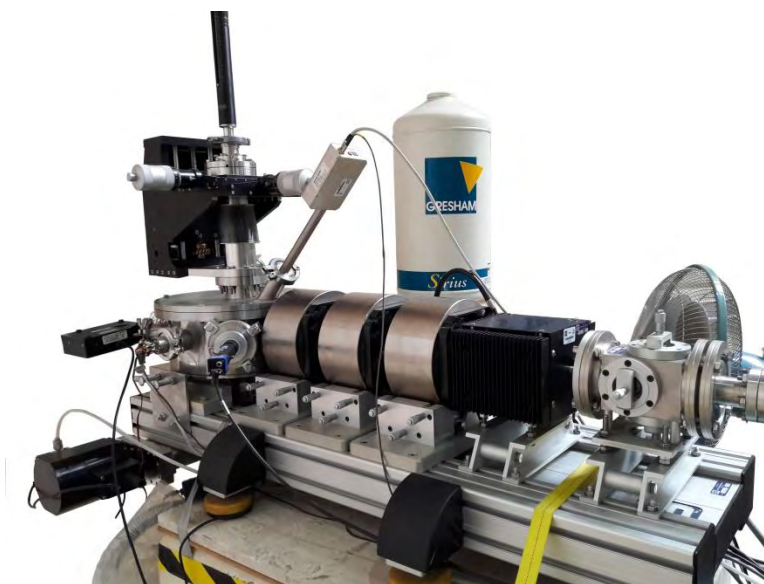
Fig. 3.4 Cuadrupolos y cámara de irradiación de la microsonda de iones, con la mesa de soporte utilizada y los diferentes componentes.
