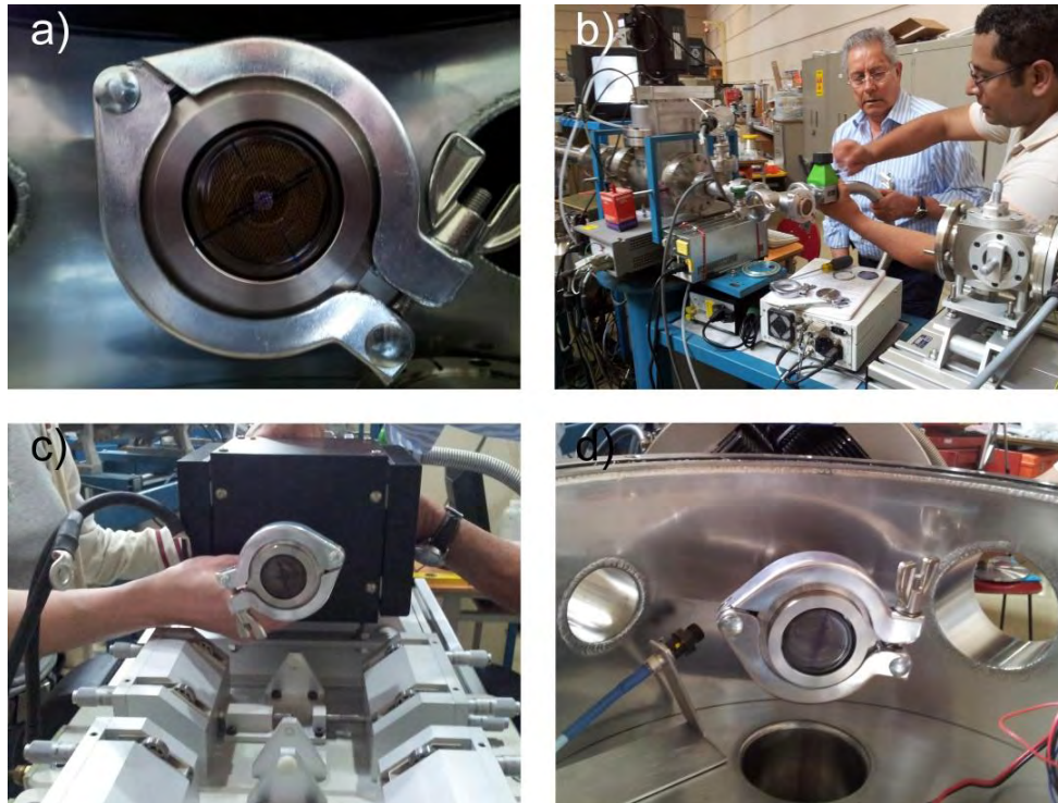
Fig. 3.6 Proceso de alineación de la línea de microsonda de iones. a) Visualización de la ionoluminiscencia visible sobre la ventana de cuarzo. b) Alineación de la línea utilizando dicha ventana. c) Alineación de la zona terminal. d) Fase final de la alineación de la terminal, vista desde adentro de la cámara de irradiación.
