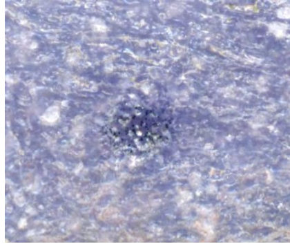
Fig. 1.2 Oscurecimiento causado por la irradiación con protones con energía de 3 MeV sobre una tesela vidriada.
