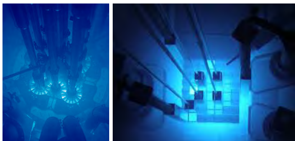
Figura 1.2: En un reactor nuclear hay una gran cantidad de partículas produciendo el efecto Cherenkov en todas direcciones, es por ello que es posible ver el destello azul. Imágenes tomadas de Wikipedia .
