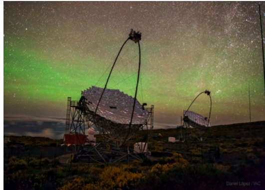
Figura 1.4: MAGIC es un arreglo de dos IACT 's de 17 m de diámetro dedicados a la observación de rayos gamma de fuentes galácticas y extragalácticas en el rango de energías entre 30 GeV's y 10 TeV's. Imagen tomada de [12].
