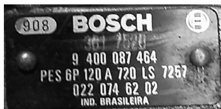
Imagen 1.2. Placa de la bomba de inyección lineal PES del laboratorio de gasificación. Elaboración propia.
