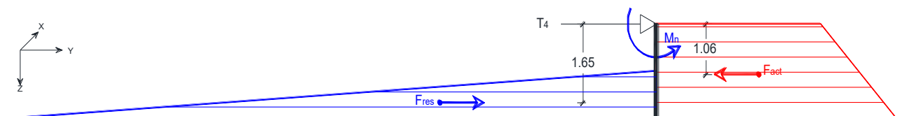
Fig. 5.11 Fuerzas que participan en la obtención del FS de la presión pasiva.
