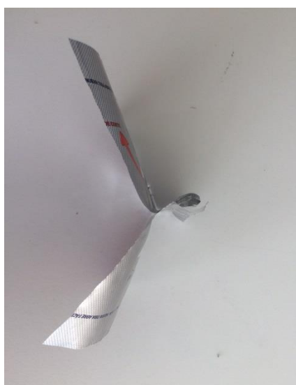
Imagen 24 -A) Proceso de sellado térmico mediante el uso del banco de sellado térmico diseñado en este trabajo 24-B) Probeta sellada cumpliendo con las medidas de la norma ASTM F88
