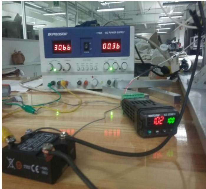
Imagen 22 Revisión e implementación del circuito de resistencias calibrando los controladores PID a 102°C
