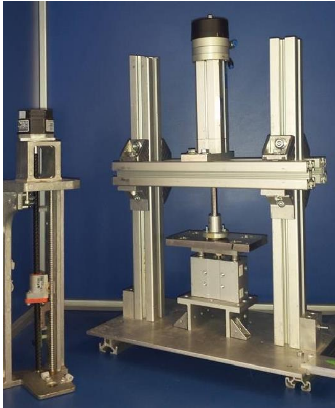
Imagen 9. Prototipos de funcionalidad limitada para banco de pruebas de sellado térmico y de tracción.
