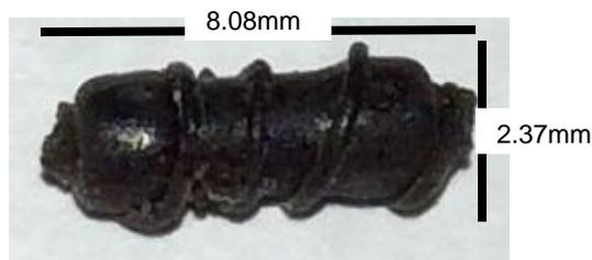
Figura 7.15 Prototipo de marcador de biopsia
