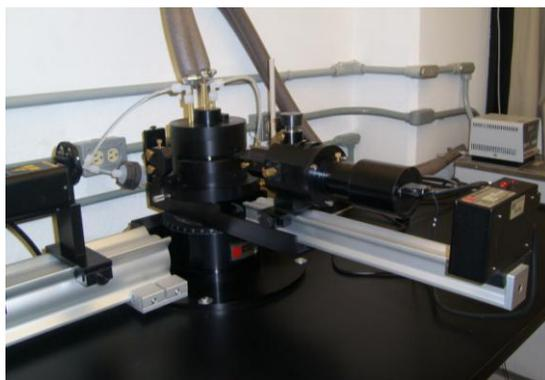
Figura 6.7 Equipo de Dispersión de Luz Dinámica (DLS)
