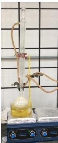
Figura 6.1 Equipo de destilación montado para la polimerización por condensación del ácido láctico.
