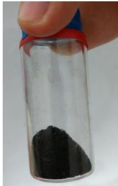
Figura 6.4 Nanopartículas magnéticas obtenidas mediante el método de coprecipitación de sales.
